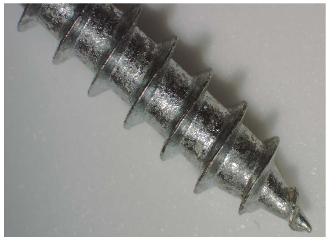
Schraube unter dem Stereomikroskop mit aktivierter Dynamikerweiterung – gleiche Einstellung der Beleuchtung wie in Abbildung links
